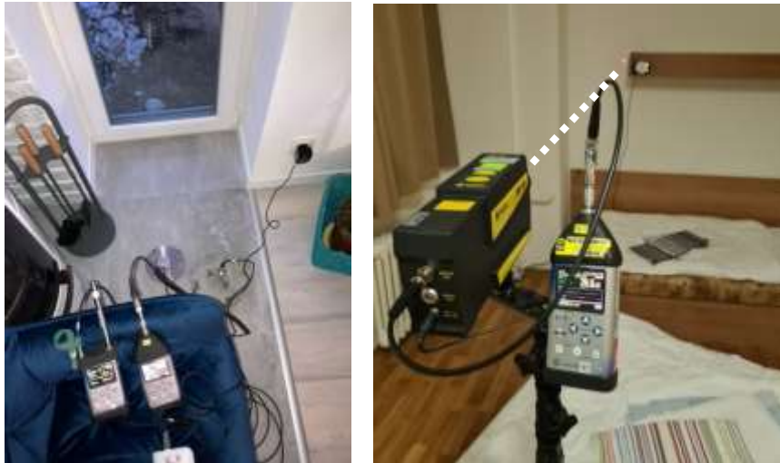
Obr. 6 Kontaktné (obr. vľavo) a bezkontaktné meranie (obr. vpravo) rýchlosti vibrácií na povrchoch, ktoré obklopujú hodnotenú miestnosť, metódou skúmania stabilného a premenlivého faktora vyžarovania zložky infrazvuku šírenej technikou seizmicitou
